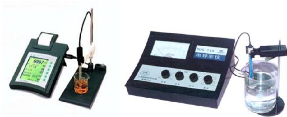
รูปที่ 5.17 เครื่องมือวัดสภาพการนำไฟฟ้าของน้ำ
