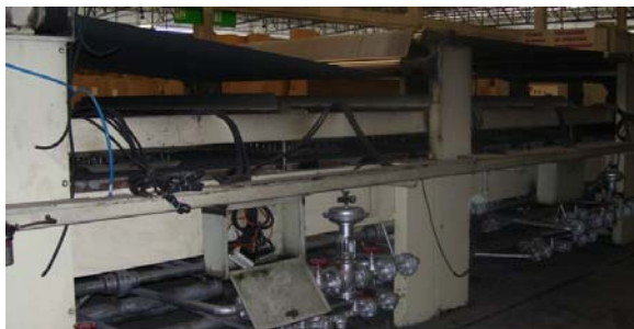
รูปที่ 5.6 Hot plate ซึ่งพื้นที่ด้านล่างไม่มีการหุ้มฉนวนกันความร้อน
