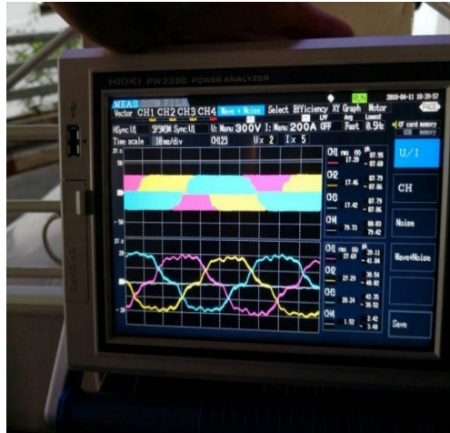
ติดตั้ง Power Analyser กับชุดควบคุม กราฟที่วัดด้วย Power Analyser HIOKI PW3390
