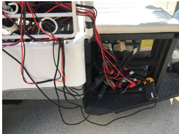
ติดตั้ง Power Analyser กับชุดควบคุม กราฟที่วัดด้วย Power Analyser HIOKI PW3390
