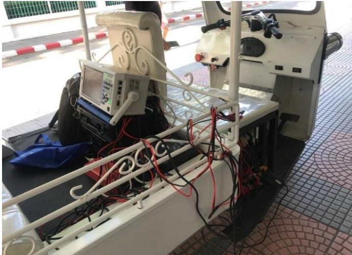
ติดตั้ง Power Analyser กับชุดควบคุม กราฟที่วัดด้วย Power Analyser HIOKI PW3390
