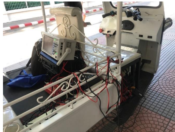
ติดตั้ง Power Analyser กับชุดควบคุม กราฟที่วัดด้วย Power Analyser HIOKI PW3390
