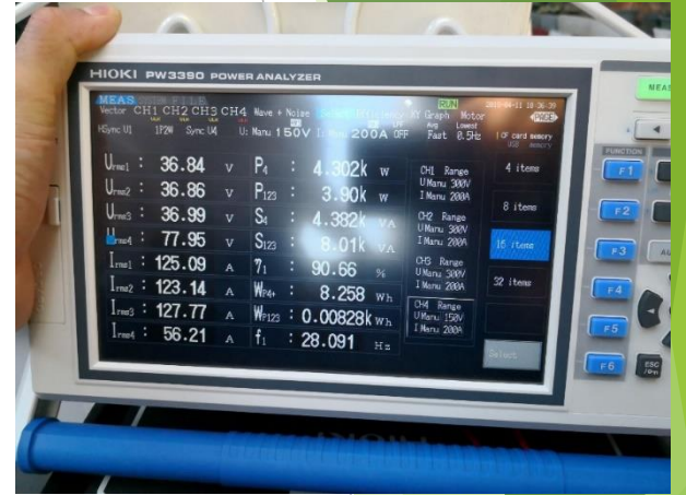
ประสิทธิภาพมอเตอร์ที่วัดด้วย Power Analyser HIOKI PW3390
