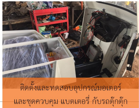
ชุดควบคุม แบตเตอรี่ และระบบไฟฟ้า กับโครงสร้างรถตุ๊กตุ๊ก
